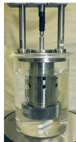
Рис. 7 – Использование стандартного стеклянного стакана вместо стального, входящего в комплект.
