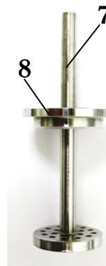
Рис. 5 – Сборка штока 7 и центрирующего кольца 8.
