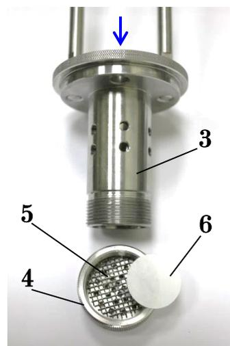
Рис. 4 – Порядок сборки ячейки-крышки: 3-ячейка-крышка, 4-гайка, 5-проволочный диск, 6- фильтровальная бумага.
