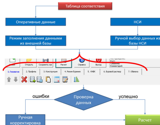
Рисунок 5 – Блок-схема модуля импорта данных из внешней базы заказчика.
