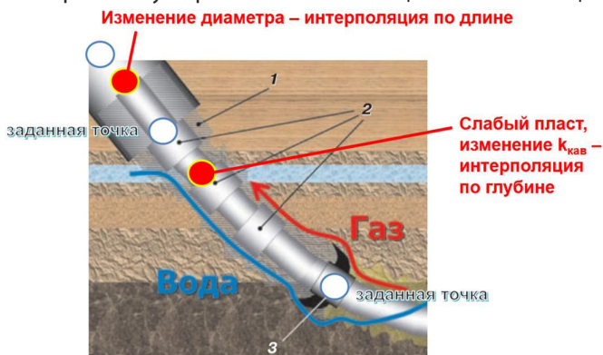
Рисунок 1 – Схема, иллюстрирующая необходимость интерполяции: по длине – при изменении диаметров конструкции или КНБК, по вертикальной глубине – при изменении кавернозности.
