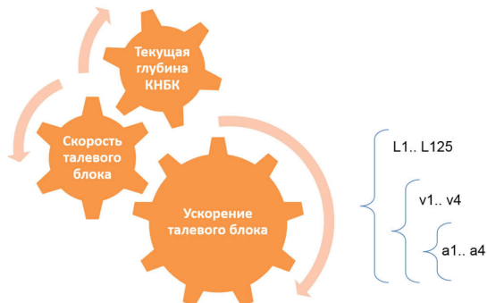
Рисунок 4 – Схема расчетных циклов для определения инерционных давлений при СПО.
