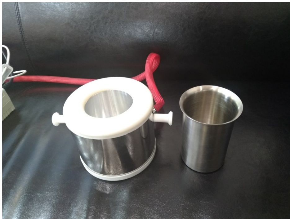
Рис. 3 – Нагревательная ячейка и стакан
