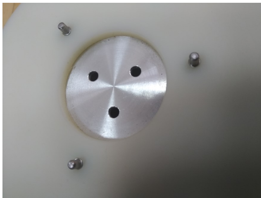
Рис. 4 – Посадочные штифты на днище ячейки.
