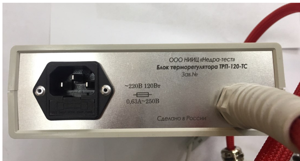
Рис. 2 – Задняя панель измерительного блока
